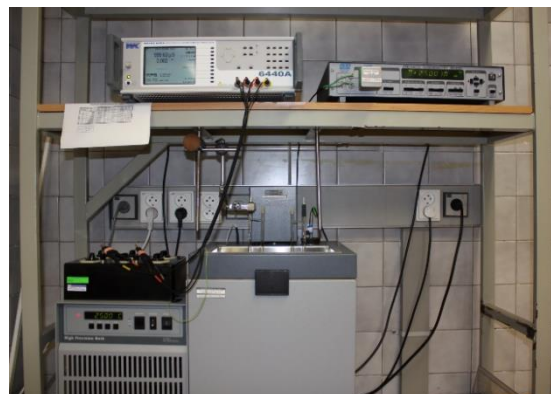
ZOSTAVA NE ELEKTROLYTICKEJ KONDUKTIVITY
