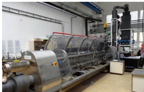
CELKOVÝ POHĽAD NA NÁRODNÝ ETALÓN PRIETOKU A PRETEČENÉHO MNOŽSTVA VODY
