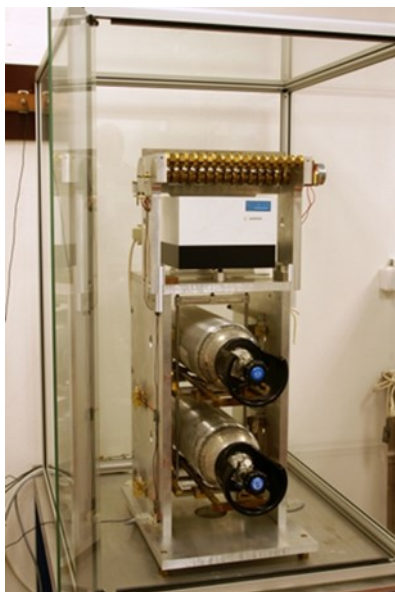
Obr. 18 Automatický systém na váženie tlakových nádob
