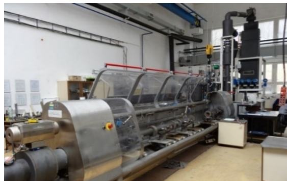
Obr. 12 Celkový pohľad na národný etalón prietoku a pretečeného množstva vody (NE 021/99)
