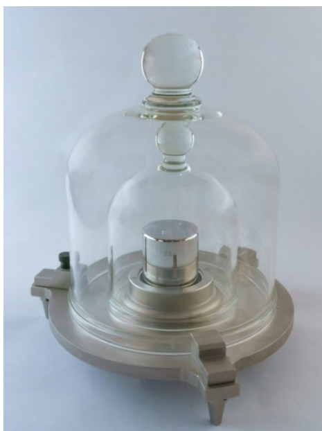
Obr. 6 Kópia medzinárodného prototypu PtIr kilogramu č. 65, súčasť NE hmotnosti
