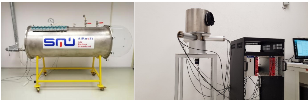
Obr. 4 Radónová komora (vľavo) a primárny etalón LSC-TDCRG (vpravo)
