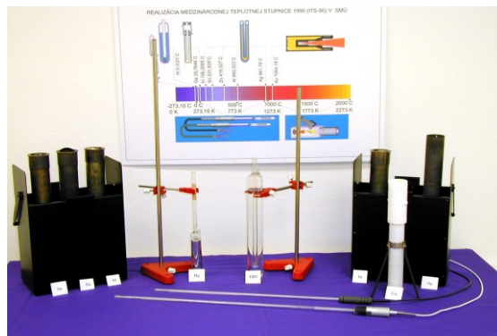
Obr. 28 Primárne definičné pevné body a etalónové odporové snímače teploty.
