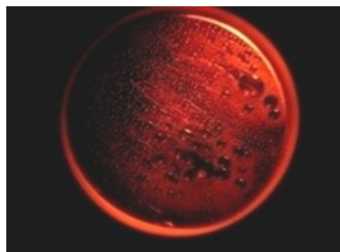
Obr. 21 Kondenzát vo forme kryštálikov rosy
